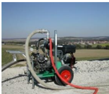
Hydrocab-080, Accessorio per la posa ad acqua nei microtubi, 80 l/min
